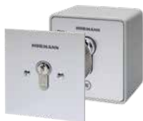
Schlüsseltaster ESU 30 / ESA 30 Unterputz- / Aufputzausführung, inkl. 3 Schlüssel, Funktion Impuls oder AUF-ZU wählbar; Zink-Druckguss-Gehäuse in Lichtgrau RAL 7040 mit Edelstahlblende (Abb. von links)
