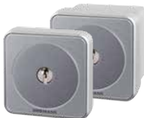
Schlüsseltaster STUP / STAP 50 Unterputz- / Aufputzausführung, inkl. 3 Schlüssel, Funktion Impuls oder AUF-ZU wählbar; Zink-Druckguss-Gehäuse in Weißaluminium RAL 9006 mit Edelstahl-Blende (Abb. von links)
