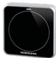
Transpondertaster TTR 1000-1 für 1 Funktion, durch Transponderschüssel oder Transponderkarte; bis zu 1000 Schlüssel oder Karten speicherbar Abmessungen: 80 x 80 x 15 mm (B x H x T); Decodergehäuse: 140 x 130 x 50 mm (B x H x T); Schaltleistung: 2,5 A / 30 V DC; 500 W / 250 V AC
