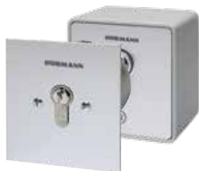
Schlüsseltaster ESU 30 / ESA 30 Unterputz- und Aufputzausführung, inkl. 3 Schlüssel, Funktion Impuls oder AUF-ZU wählbar; Zink-Druckguss-Gehäuse in Lichtgrau RAL 7040 mit Edelstahlblende; Schutzart: IP 54 (Abb. von links)
