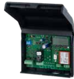
Decodergehäuse für Codetaster CTR 1b-1, CTR 3b-1, CTV 3-1, CTP 3 Abmessungen: 140 x 130 x 50 mm (B x H x T), Schaltleistung: 2,5 A / 30 V DC 500 W / 250 V AC
