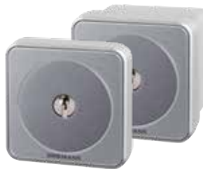
Schlüsseltaster STUP 50 / STAP 50 Unterputz- und Aufputzausführung, inkl. 3 Schlüssel, Funktion Impuls oder AUF-ZU wählbar; Zink-Druckguss-Gehäuse in Weißaluminium RAL 9006 mit Edelstahlblende, Schutzart: IP 54 (Abb. von links)
