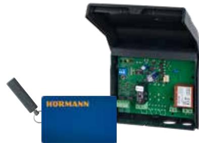
Transpondertaster TTR 1000-1 für 1 Funktion, durch Transponderschüssel oder Transponderkarte; bis zu 1000 Schlüssel oder Karten speicherbar Abmessungen: 80 x 80 x 15 mm (B x H x T); Decodergehäuse: 140 x 130 x 50 mm (B x H x T); Schaltleistung: 2,5 A / 30 V DC; 500 W / 250 V AC
