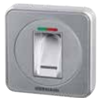
Fingerleser FL 150 für 2 Funktionen; bis zu 150 Fingerabdrücke speicherbar Abmessungen: 80 x 80 x 13 mm (B x H x T); Decodergehäuse: 70 x 275 x 50 mm (B x H x T); Schaltleistung: 2,0 A / 30 V DC
